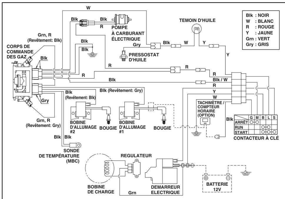
L'équipement facultatif est indiqué en pointillé. Choisir des câbles de section appropriée et raccorder la batterie comme indiqué par les traits en pointillé sur le schéma de câblage.
