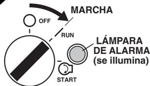
Si una caja de mando está instalada, girar el interruptor y ajustarlo a la posición "MARCHA" (RUN). Comprobar que se ilumina la lámpara de alarma y otras lámparas (de rojo).
