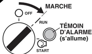
Si une boîte de commande est installée, tourner le contacteur à clé et le régler à la position (MARCHÉ). Vérifier que le témoin d'alarme et autres témoins sont bien illuminés (en rouge).
