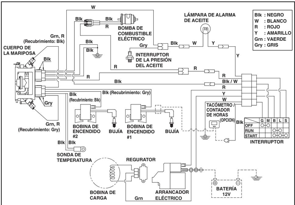
Equipamiento opcional en líneas discontinuas. Seleccione cables de cala apropiada y conecte la batería según se muestra en la línea discontinua del diagrama de cableado.
