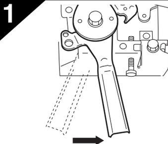
Mettre le levier en position de ralenti et faire tourner le moteur ainsi pendant 2 à 3 minutes, avant de l'arrêter.
