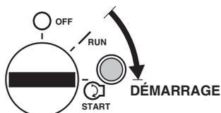
Insérer la clé dans le contacteur et mettre sur la position (DÉMARRAGE) pour démarre le moteur.
