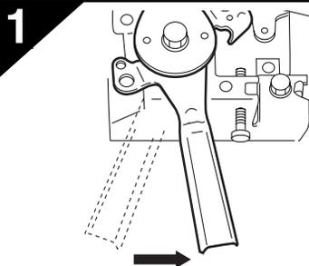
Sitúe la palanca del acelerador en la posición de baja velocidad y deje que el motor funcione durante 2 ó 3 minutos sin carga.
