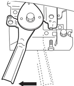
Mueva gradualmente la palanca hacia la posición de alta velocidad y sitúela en la velocidad requerida.
