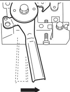
Una vez encendido el motor, sitúe la palanca del acelerador en la posición de baja velocidad y deje que se caliente el motor sin carga durante unos minutos.
