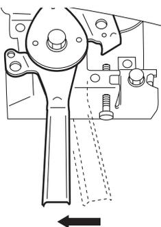
Sitúe la palanca del acelerador a 1/3 de distancia hacia la posición de máxima velocidad.
